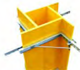
Girosquadra per getto pilastri zincato 150-450mm 500-950mm peso 2,35kg
