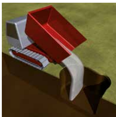
2a. ALLESTIMENTO DELLA SOLETTA DI BASE
