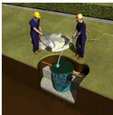
5a. RINFIANCO DELLO SCAVO
