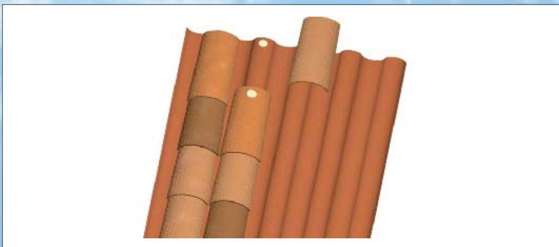
**Fig. 57 - Installazione coppi con colla antigeliva - colla poliuretanica non espansiva**
