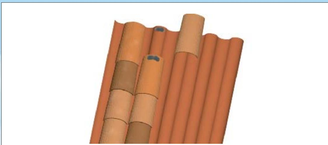
**Fig. 56 - Installazione coppi con malta a base in cemento**
