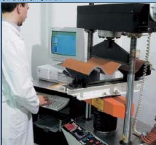
Fig. 8 - Prova di carico
