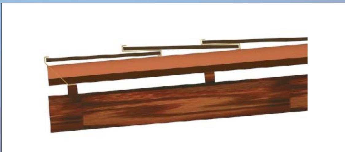
**Fig. 58 - Installazione coppi con grappe in rame**
